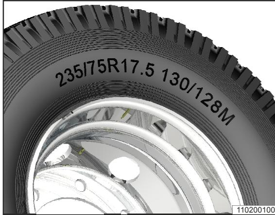
Информация о давлении воздуха в шинах приведена в разделе «Технические характеристики». Допустимое отклонение давления в шинах должно находиться в пределах  $\pm 20$  кПа
